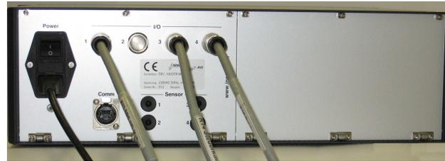
Rückwandansicht Messgerät DEC-100DTR Maxi
