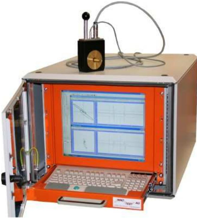
Draht- Rohr- und Stabprüfsystem UMFEC-DRSP5, bestehend aus Messgerät DEC-200SP Station im Kleingeräteschrank, Prüfspule und Prüfkabel sowie der Betriebssoftware BPSWS (2 Kanäle)
