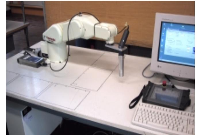
Robotergestützter Luftultraschall-Mess- und Kalibrierplatz
