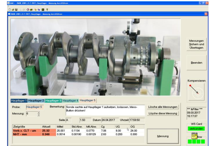
Fig. 2 Hauptmessfenster der benutzergesteuerten Bediensoftware AMC 5.x
