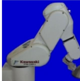
Mit Hilfe unseres Roboters und eines zusätzlichen Drehtellers, ist es möglich, mittels Wirbelstrom beliebige rotationssymmetrische Bauteile bildgebend auf Oberflächenfehler (Risse, Poren) zu prüfen. Bei dünnwandigen (je nach Werkstoff ca. 1 mm bis
