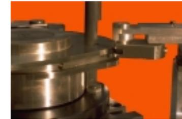
Ebenfalls mittels dem Wirbelstromverfahren wurde eine Prüftechnik entwickelt, welche die Detektion von Schleifbrand auf der Lauffläche von Nockenscheiben erlaubt.
